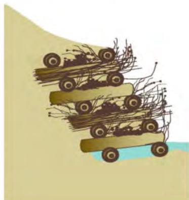
Esquema d'un entramat de doble paret tipus "Krainer"
