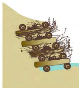
Esquema de un entramado de doble pared tipo "Krainer"
