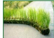
**Fiber roll<sup>TM</sup>** Rollo de fibra de coco compactada estructurada en una malla de polipropileno de 50 mm y hilo de 2,5mm de diámetro. El estándar tiene las siguientes dimensiones: 3 m de longitud, 0,3 m de diámetro y 10,9 kg/ m.l.
