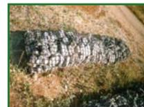
**Chamber revetment<sub>TM</sub>** Gavión laminar de 1,5x2x0,3 m. de 400 kg/m<sup>2</sup>, compartimentado en cinco cámaras, relleno de piedra, estructurado en una red de polietileno de 45mm de malla y 6,5 mm de grueso.
